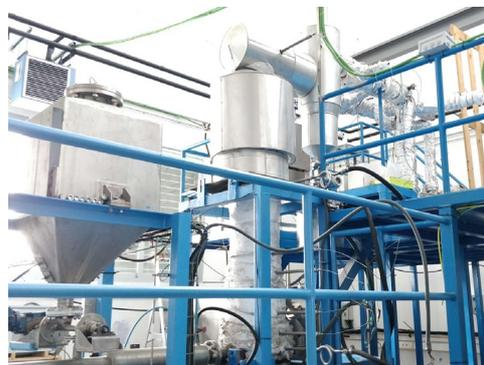
En esta instalación se han llevado a cabo experimentos de gasificación de fango de EDAR, compost, y RDF (fracción combustible de los residuos sólidos urbanos), estudiándose la cantidad y calidad del gas obtenido, así como los subproductos de la gasificación. La planta cuenta con todos los sistemas "on line" de seguimiento tanto de la producción de volátiles condensables (TAR), como de la composición del gas (incluido el NH<sub>3</sub>).
